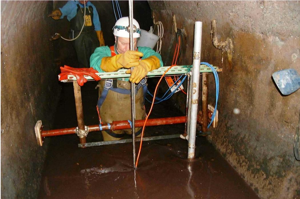
Figure 22. Mise en œuvre d'un courantomètre pour l'exploration du champ de vitesses dans un collecteur
