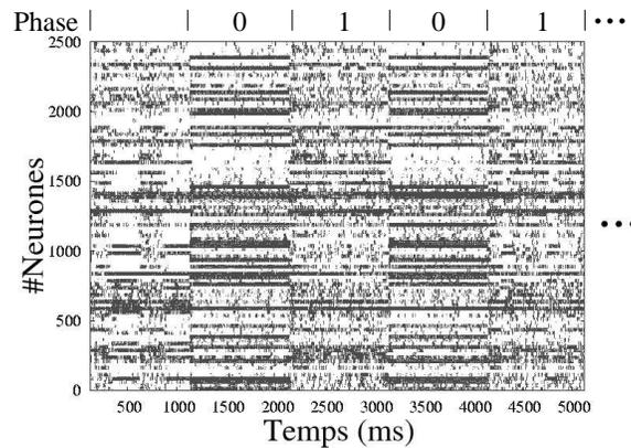
FIG. 3 – Illustration du protocole de stimulation du réseau. *En haut* : Représentation schématique de l'alternance des phases d'activité (phase 0) et de repos (phase 1). *En bas* : Diagramme de trains de PAs dans le temps, correspondant à tous les neurones internes du réseau.
